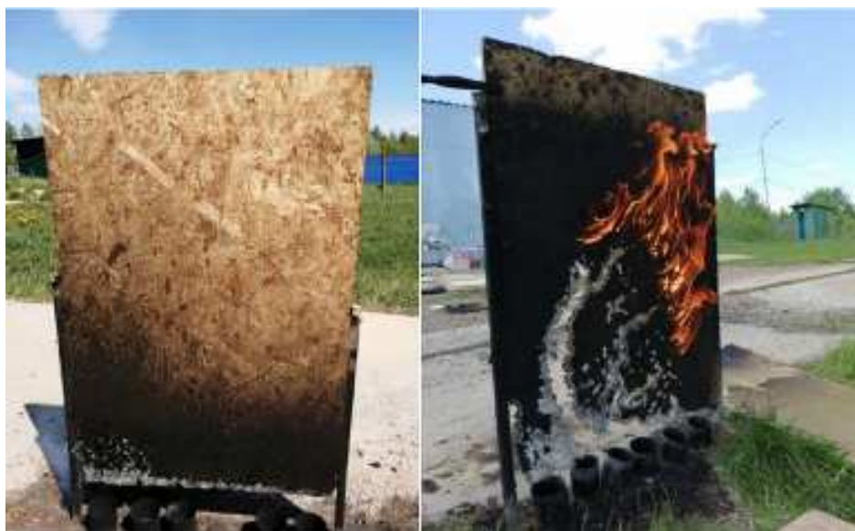
Рис. 1. Фотографии, полученные при натуральных огневых испытаниях ОСП-плиты
