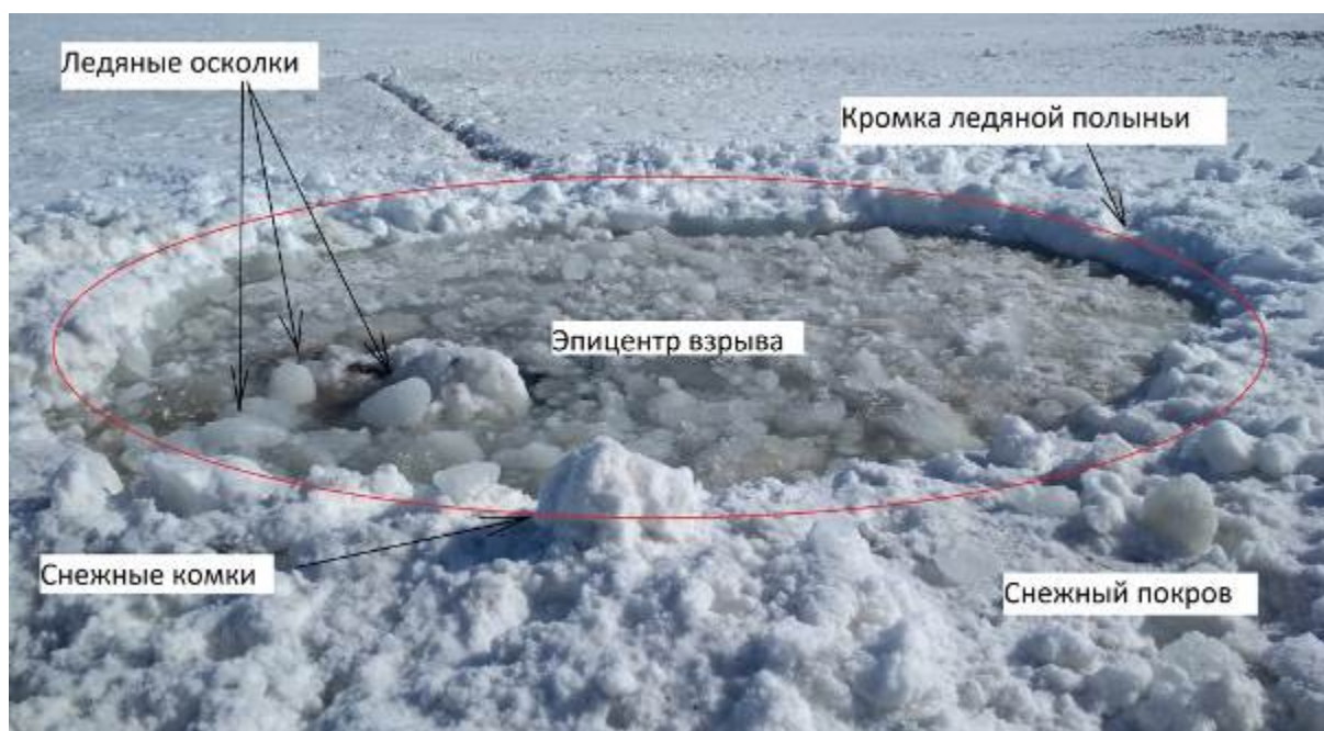
Рис. 1. Результаты UNDEX-эксперимента 2020. Взрыв – ООО КузбасСпецВзрыв. Фото получено через 15 мин после взрыва
