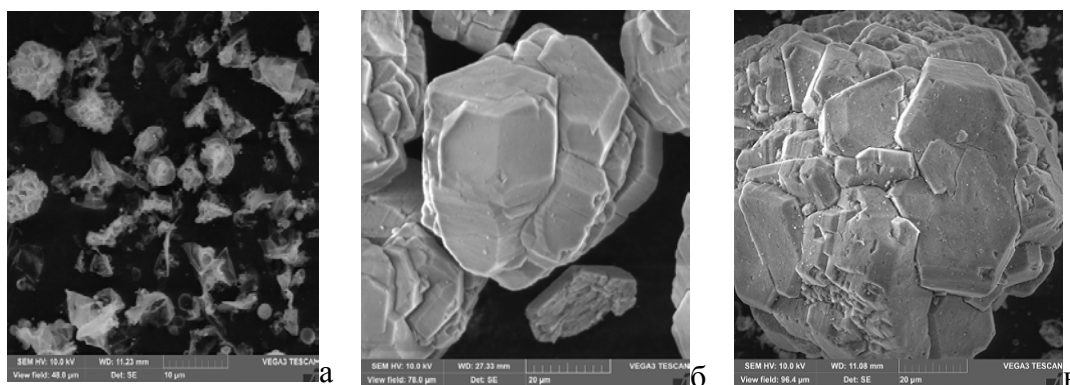
Рис. 1. Исходные структуры порошков а) ZrO_2-MgO , б) Al_2O_3 и в) структура конгломерата после мехактивации
